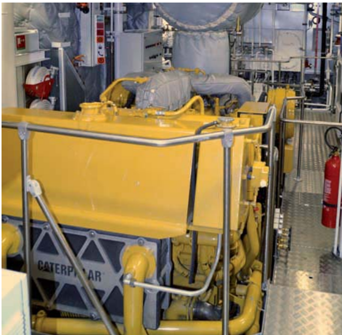
Mit einem 1425 kW leistenden Caterpillar-Hauptmotor erreicht die „Rainbow Warrior“ eine Geschwindigkeit von bis zu 15 kn
